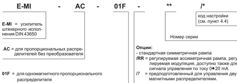
По запросу доступно исполнение с кабельным соединителем типа M12 (вместо внутренних винтовых контактов), код заказа E-MI-AC-01F(05F)/M12
